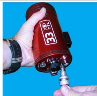
Per evitare che eventuali goccioline entrino nel corpo macchina tenere l'obiettivo rivolto verso il basso quando questo viene tolto. Nel sostituire la pellicola, aprire lo sportello sempre verso il basso. Anche la presa del flash necessita di un po' d'attenzione: è sufficiente tenere la sede sinora rivolta verso il basso al momento del disinnescio.
